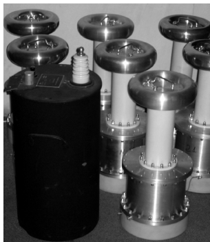
Рис. 4. Популярный советский конденсатор Р51 (испытательное напряжение 15 кВ) и конденсаторы КГИ-100 (испытательное напряжение 125 кВ)
