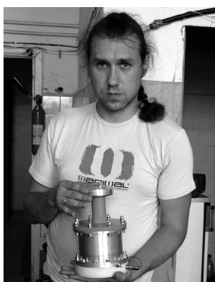
Рис. 2. Новый КГИ-10 с нулевым избыточным давлением элегаза, испытательное напряжение до 22 кВ
